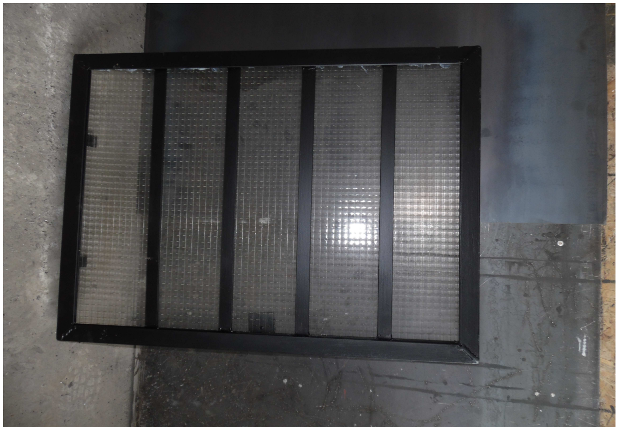
Wykonanie metalowego okienka piwnicznego.
